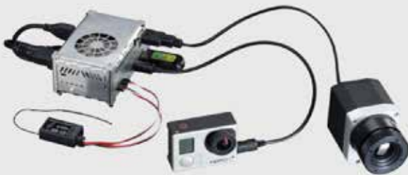
与GoPro可见光相机，GPS USB闪存和2.4GHZ飞行控制接收器等集成
